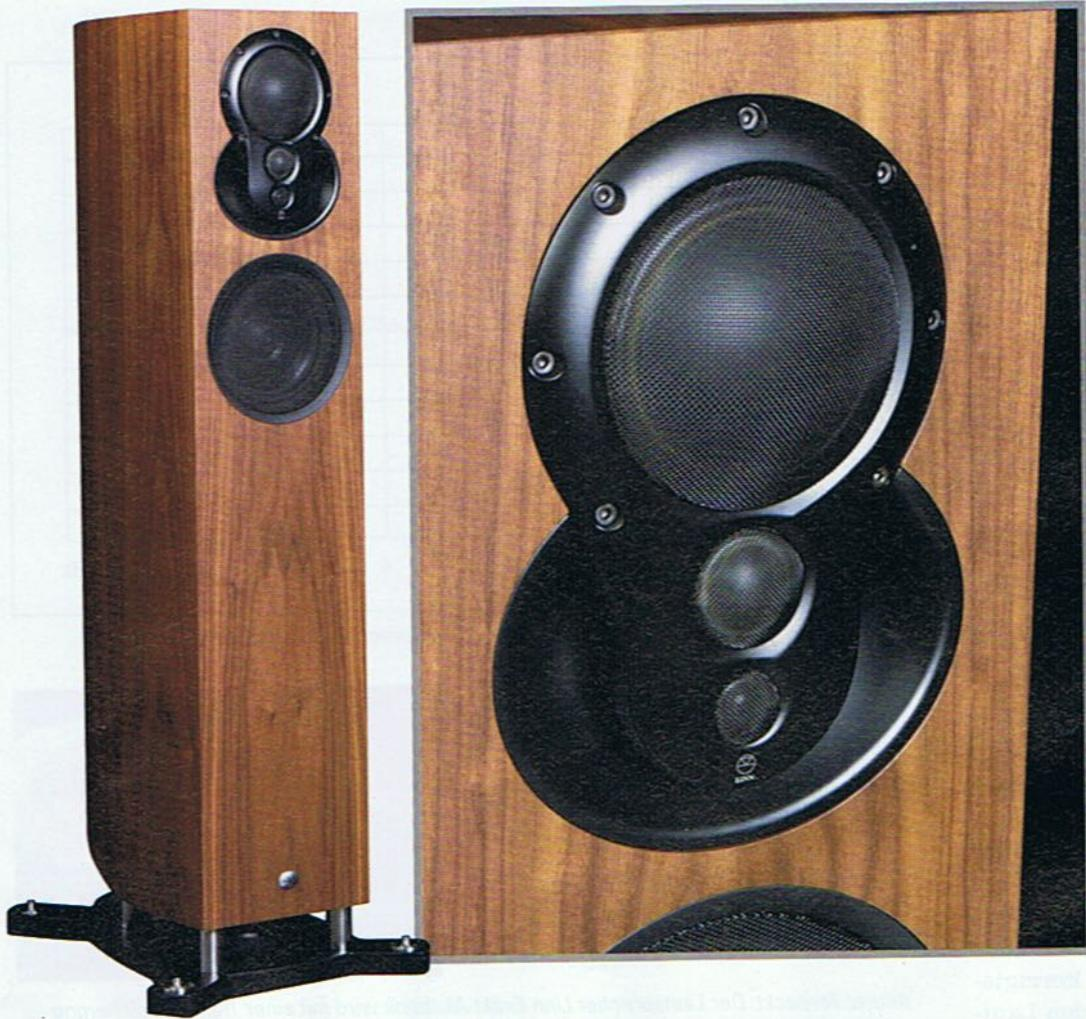
Die Mittel-, Hoch- und Superhochtöner befinden sich auf einer eigenen Schallwand aus Aluminium. Bei der Aussparung dahinter handelt es sich keinesfalls um eine Reflexöffnung. Die nach hinten geschlossene Öffnung soll das Rundstrahlverhalten der Lautsprecherchassis optimieren und Kantenreflexionen verringern. Direkt unter dem Array sitzt ein 18-Zentimeter-(cm)-Tiefmitteltöner. Die beiden 20-cm-Push-Pull-Tieftöner schließen das 5-Wege-System ab
