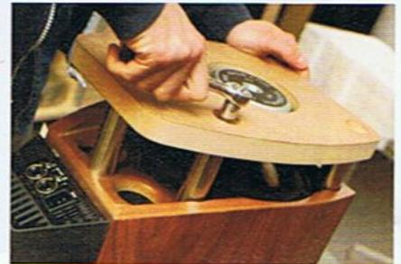
*Akurat verpackt: Der Lautsprecher Linn Exakt Akubarik wird mit einer Transportsicherung aus Holz geliefert, die zuerst gegen eine abgesetzte Bodenplatte aus Metall ausgetauscht wird. Im nächsten Schritt werden daran die Spike-FüÙe angeschraubt. Werkzeug und Zubehör liegen den Lautsprechern natürlich bei*
