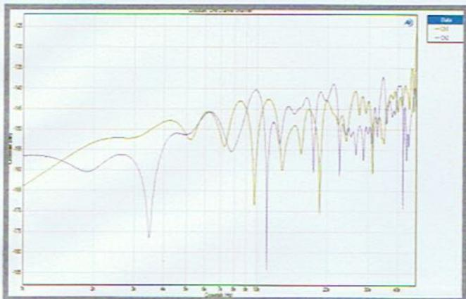
Wir haben uns den Spaß erlaubt und den Akurate Exakt an seinen HDMI-Ausgängen durch unser Messlabor gejagt. Die Crosstalk-Messung ergibt einen einzigartigen Wert von  $-145$  dB bei  $10$  kHz
