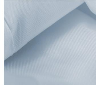
Der strukturierte Aufbau des Polyamid-Filtermediums mit fortschrittlicher Composite-Layer-Technologie garantiert präzise Abscheideraten von 0.4 – 50 µm bei einer Rückhalteeffizienz von 99.9% (Beta 1000).
