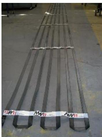
Figure 2-2 : serpentin chauffant de mise hors gel
