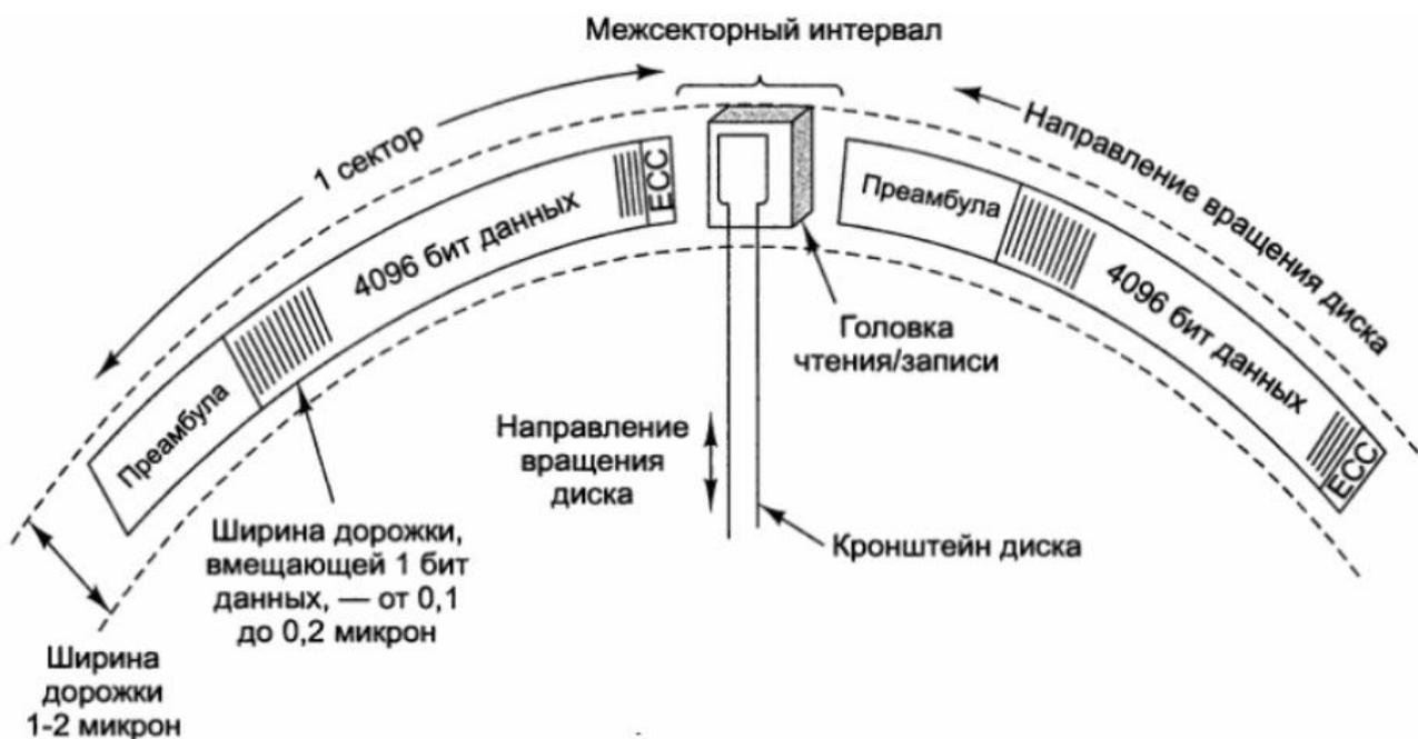
**Дорожкой** называется круговая последовательность битов, записанных на диск за его полный оборот. Каждая дорожка делится на секторы фиксированной длины.
