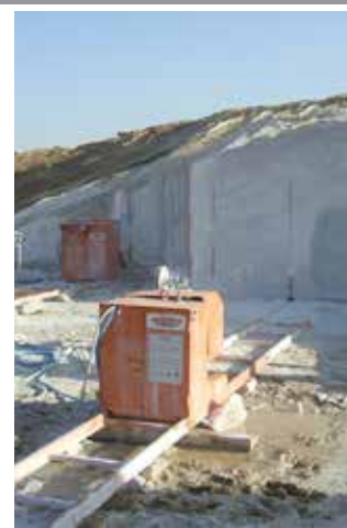
Tagliatrice a filo diamantato MINI-FIL Diamond wire sawing machine MINI-FIL
