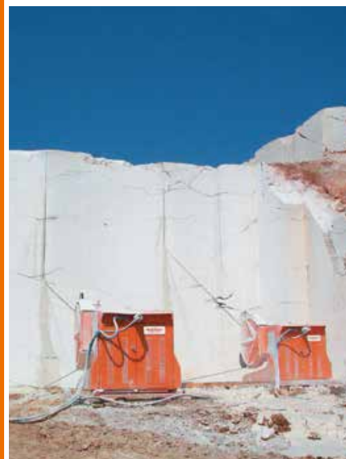
Tagliatrice a filo diamantato MAR-FIL SUPER Diamond wire sawing machine MAR-FIL SUPER
