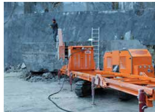
Tagliatrice a filo diamantato MAR-FIL SUPER Diamond wire sawing machine MAR-FIL SUPER
