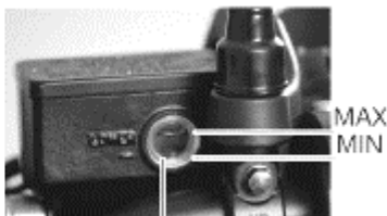
Sichtfenster für die hintere Bremsflüssigkeit
