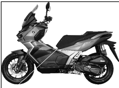
Sicherungskasten im Batteriefach
